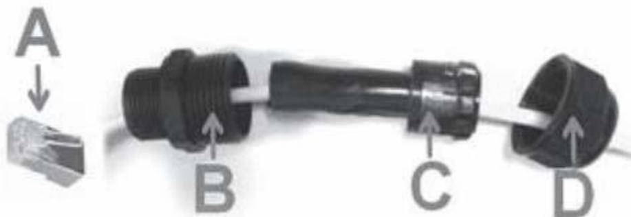
4) 将网线水晶头插入 AP 设备的 ETH/POE 接口，按照 B、C、D 的顺序拧紧防水 PG 头，完成网线的安装。
